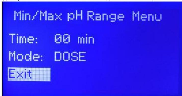
В качестве последней опции введите Time (время) (максимально 99 минут), после чего, если остаётся состояние более низкого или более высокого значения, то происходит тревога (сигнал) (следует установить в поле режима).
