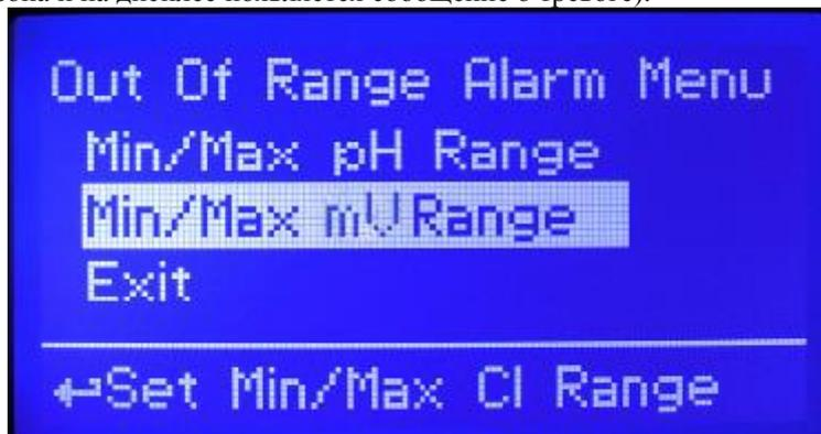
Поверните колёсико в положение Min/Max mV Range (минимальный/максимальный диапазон mV) и установите условие «out of range» (выход из диапазона) для зонда ОВП, после чего кликните колёсиком, и войдите в Min/Max Range menu (Меню минимального/максимального диапазона).
