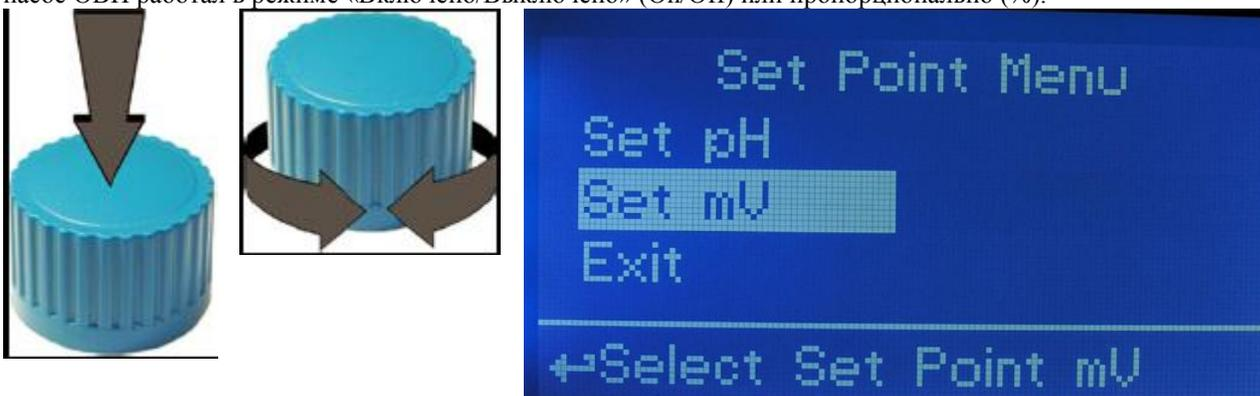
В режиме On/Off (вкл./выкл.) Автоматическая станция обработки воды Cl, pH Micromaster WDPHRH работает, используя два установленных значения, которые включают или выключают насос ОВП. Для использования этого режима переместите курсор в положение «Working Mode» (Рабочий режим). Нажмите колёсико и выберите его.
