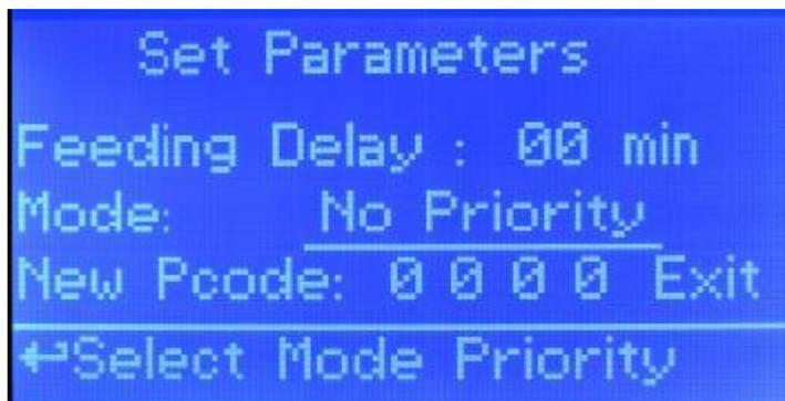
Перейдите к «Feeding Delay» (Задержка запитки) и нажмите колёсико. Выберите значение между 0 (отключено) и 60 минут (максимальное время задержки). Данная функция может быть использована для согласования задержки пуска на насосах. Задержка происходит, когда на прибор подаётся электропитание или после возвращения контакта NO FLOW (нет потока).
