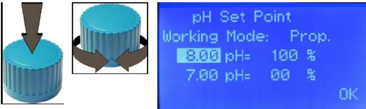
Режим (%) «пропорционально» между 7pH (0%) и 8 pH (100%). [Настройка хода 180]
