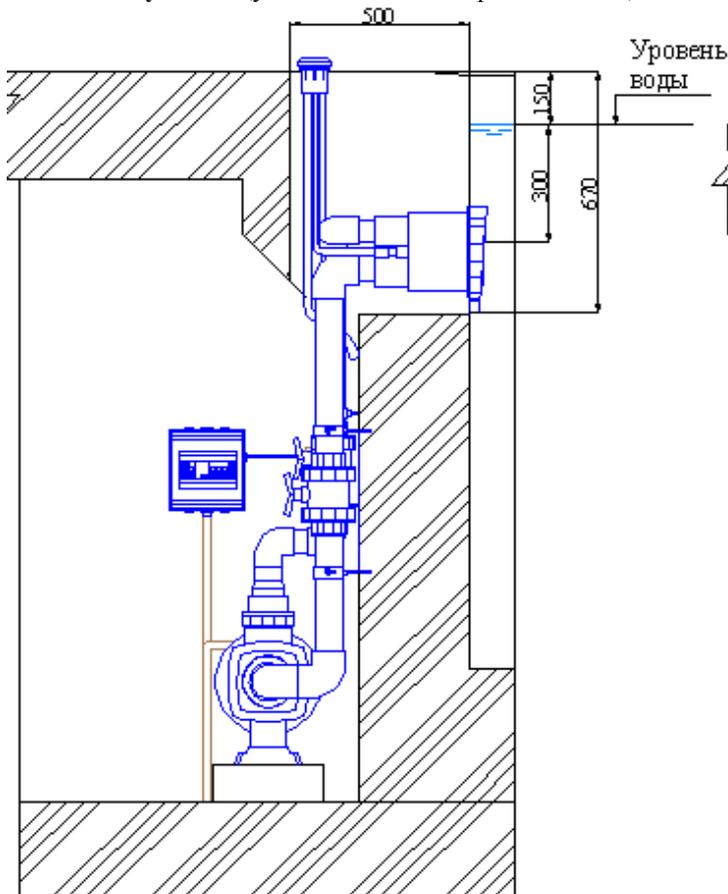
**Рисунок 12** (установка в переливной бассейн)
